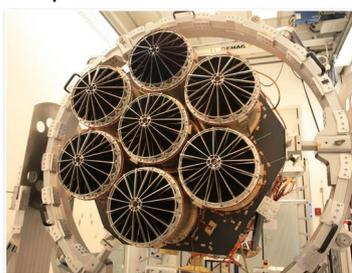
eROSITA's 7 Röntgenspiegelteleskope (Predehl, MPE, IRT)
