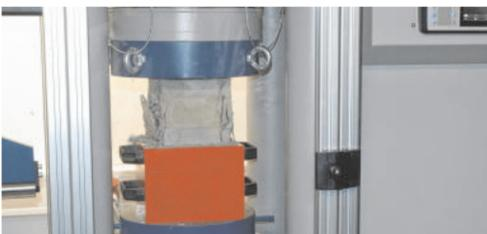
**Mit der Druck- und Biegeprüfmaschine** im Labor für Baustoffe erfolgt die normgerechte Bestimmung der Druckfestigkeit von Betonen. FOTO MARTIN ILLNER
