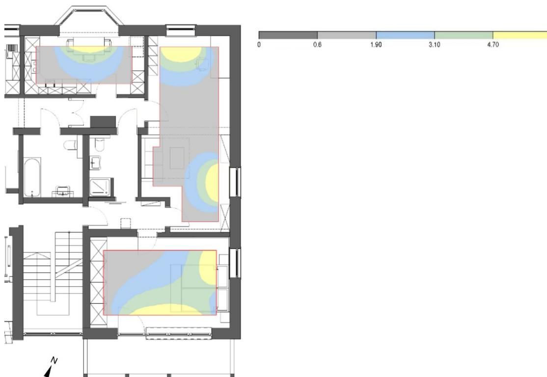
Abbildung 115: Simulationsergebnisse der Tageslichtversorgung, durchgeführt und bewertet nach DIN EN 17037: nur das Schlafzimmer ist ausreichend mit Tageslicht versorgt
