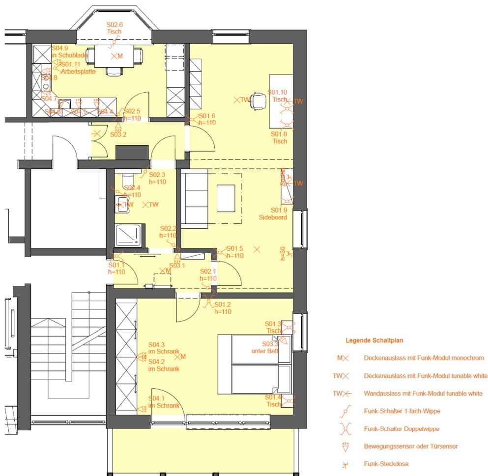
Abbildung 130: Steuerungsplan inkl. Schalter, Sensoren und Funk-Modulen für Leuchten; detaillierte Informationen zu den Leuchten und den zugehörigen Funk-Modulen befinden sich im Leuchtenbuch im Anhang
