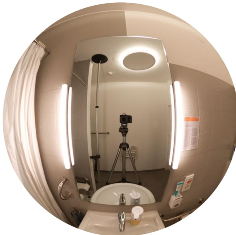
Abbildung 188: Lichtszene „abends“; während der Befragung waren die Spiegelleuchten und der Indirektanteil der Deckenleuchte eingeschaltet (Deckenleuchte: 2.700K, Indirektanteil: 100% Helligkeit, Direktanteil: 0%; Spiegelleuchten: 2.700K, 100% Helligkeit); Position im Badezimmer, vor dem Spiegel stehend mit Blick geradeaus ( $0^\circ$ , horizontal), Messpunkt: 5.1.3wwn-0; Ergebnisse der Leuchtdichteaufnahmen befinden sich im Messprotokoll im Anhang
