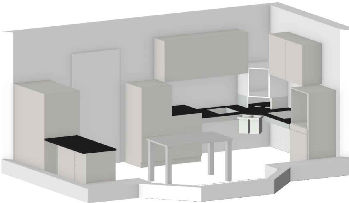
*Abbildung 125: 3D-Modell der Küche; links der Tür: Apothekerschränke, statische Arbeitsplatte und Rollcontainer; rechts der Tür (von li. nach re.): Kühlschrank, Geschirrspüler, höhenverstellbare Arbeitsplatte (mit Waschbecken, Abfalleimer mit Einwurf-Öffnung in der Arbeitsplatte und Kochfeld), Backofen und Stauraum darunter, in den Oberschränken ist weiterer Stauraum vorhanden*
