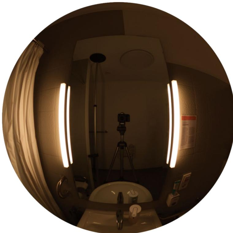
*Abbildung 181: Lichtszene „nachts“; während der Befragung waren nur die Spiegelleuchten eingeschaltet (2.200K, 10% Helligkeit); Position im Badezimmer, vor dem Spiegel stehend mit Blick geradeaus ( $0^\circ$ , horizontal), Messpunkt: 5.1.2swwn-0; Ergebnisse der Leuchtdichteaufnahmen befinden sich im Messprotokoll im Anhang*
