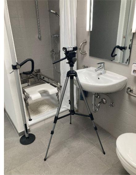
Abbildung 136: Messaufbau der Position Badezimmer, vor dem Spiegel sitzend mit Blick geradeaus in den Spiegel ( $0^\circ$ , horizontal)
