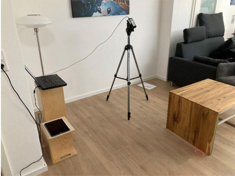
Abbildung 135: Messaufbau für die Position Wohnzimmer, auf dem Sofa sitzend mit Blick nach unten ( $-45^\circ$ ); detaillierte Informationen zum Messaufbau befinden sich im Anhang
