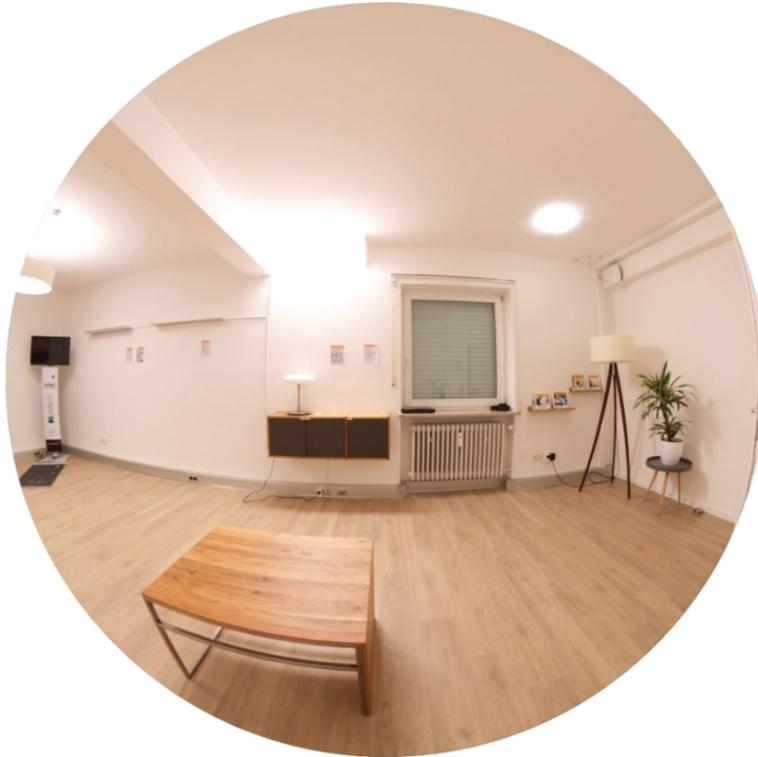
*Abbildung 144: Lichtszene „tagsüber“ von Hohlkehle (Prototyp); während der Befragung war nur die Hohlkehle eingeschaltet (4.500K, 100% Helligkeit); Position im Wohnzimmer, auf dem Sofa sitzend mit Blick geradeaus (0°, horizontal), Messpunkt: 2.2.9nwn-0; Ergebnisse der Leuchtdichteaufnahmen befinden sich im Messprotokoll im Anhang*
