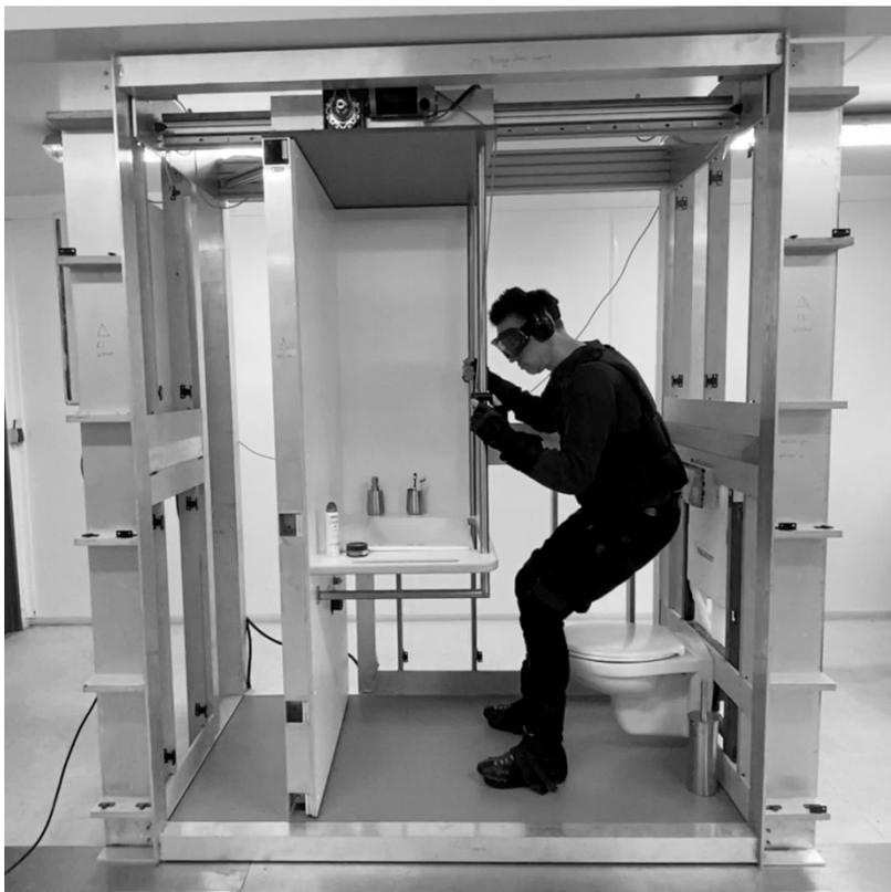
Abbildung 43: Selbsttest im Alterssimulationsanzug am Demonstrator-02
