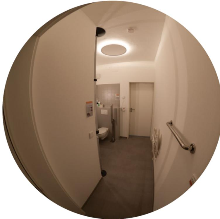
Abbildung 187: Lichtszene „abends“; während der Befragung waren die Spiegelleuchten und der Indirektanteil der Deckenleuchte eingeschaltet (Deckenleuchte: 2.700K, Indirektanteil: 100% Helligkeit, Direktanteil: 0%; Spiegelleuchten: 2.700K, 100% Helligkeit); Position im Badezimmer, in der Tür stehend mit Blick nach unten ( $-10^\circ$ ), Messpunkt: 5.3.3wwn-10; Ergebnisse der Leuchtdichteaufnahmen befinden sich im Messprotokoll im Anhang
