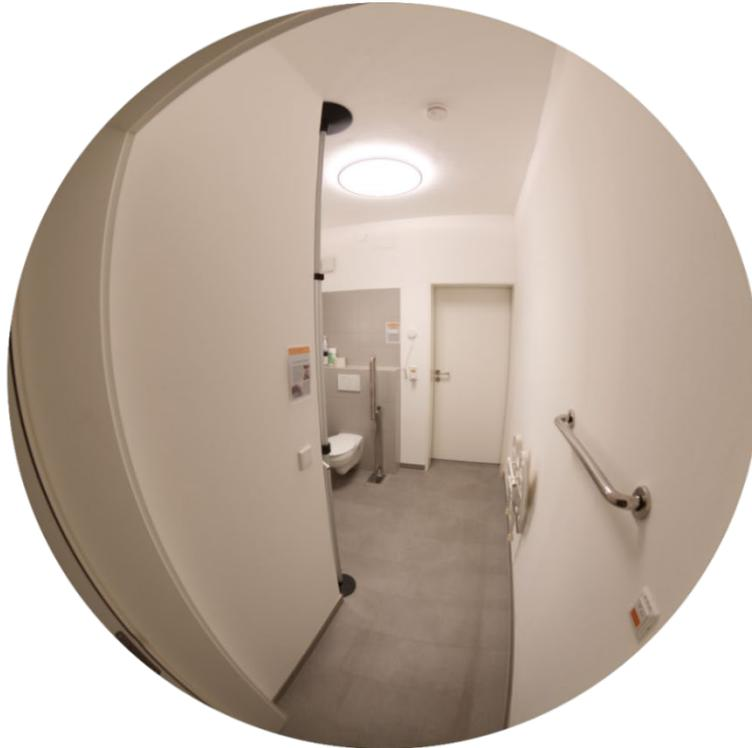
Abbildung 185: Lichtszene „tagsüber“; während der Befragung waren alle Leuchten eingeschaltet (Deckenleuchte: 4.500K, 100% Helligkeit; Spiegelleuchten: 4.500K, 70% Helligkeit); Position im Badezimmer, in der Tür stehend mit Blick nach unten (-10°), Messpunkt: 5.3.3nwn-10; Ergebnisse der Leuchtdichteaufnahmen befinden sich im Messprotokoll im Anhang
