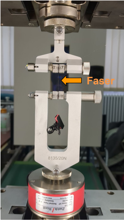
Einzelfaserfestigkeitsprüfung ZwickRoell Universalprüfmaschine – 20N angelehnt an ISO-11566
