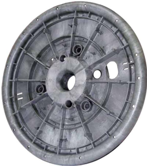
Bild 3: Schäumbauteil mit sichtbaren Schlieren [4]
