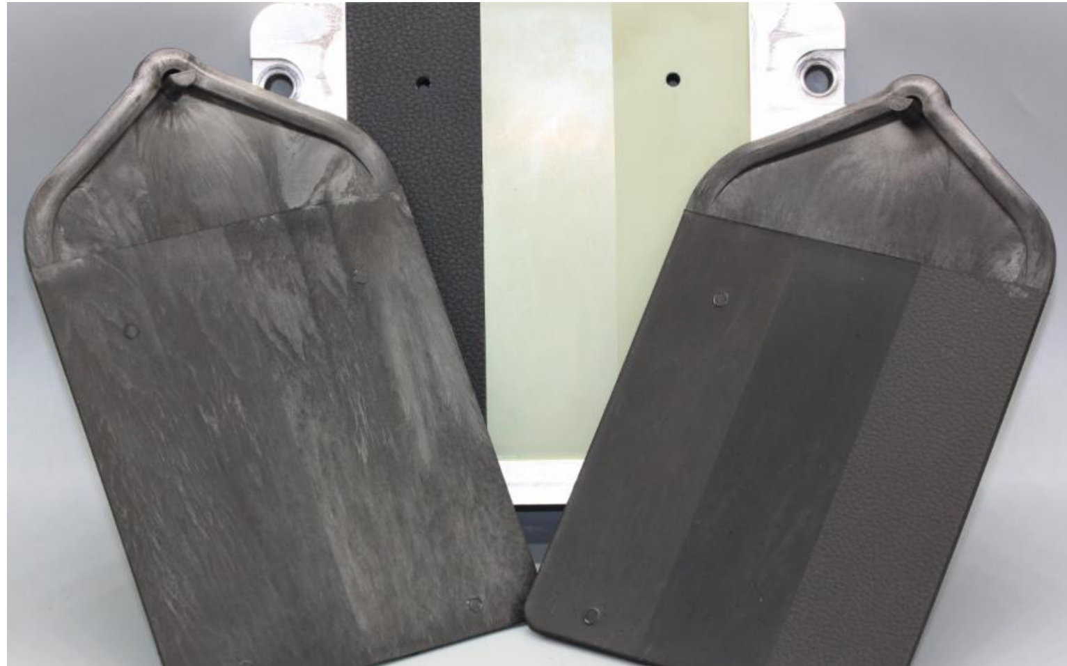
Bild 1: Unterschiedliche Oberflächenqualität beim TSG, Bildquelle Hopmann & Walkers, IKV [1]
