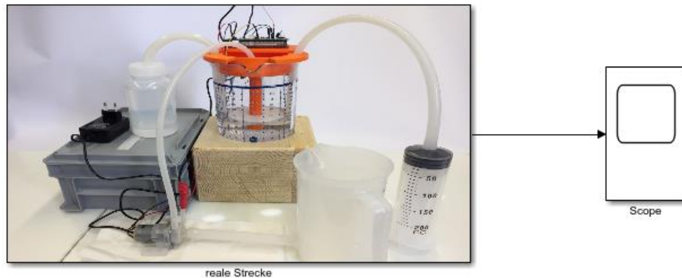
Abbildung 22: Blockschaltbild für die antike Lösung der Füllstandsregelung
