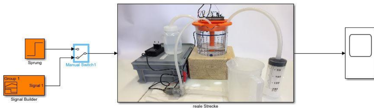
Abbildung 26: Blockschaltbild zur Erzeugung des eigenen erstellten Signals mit Signal Builder
