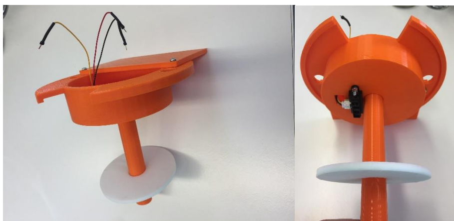
Abbildung 15: verschraubte 3D-Druck-Einzelteile & IR-Sensor an Unterseite des Deckels angeschraubt
