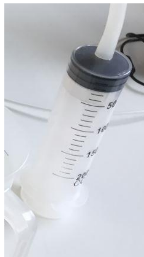
Abbildung 17: Wasserspritze als Störung
