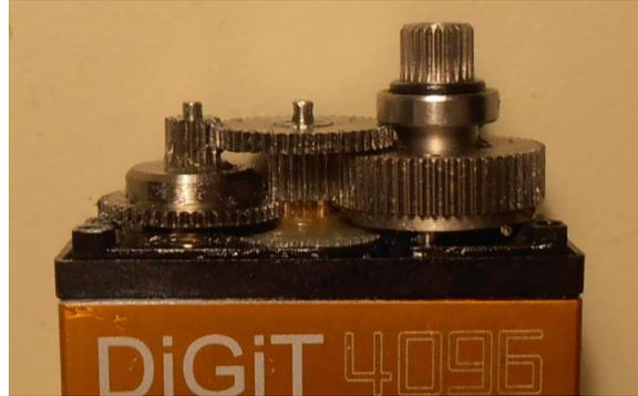
Abbildung 10: Getriebeeinheit vom Savöx SV-1270
