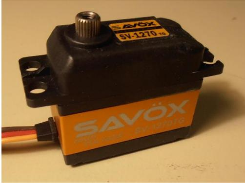
Abbildung 9: Modellbauservomotor Savöx SV-1270
