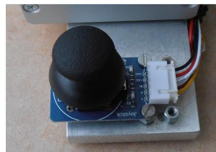
Abbildung 38: Analoges Fingerjoystick
