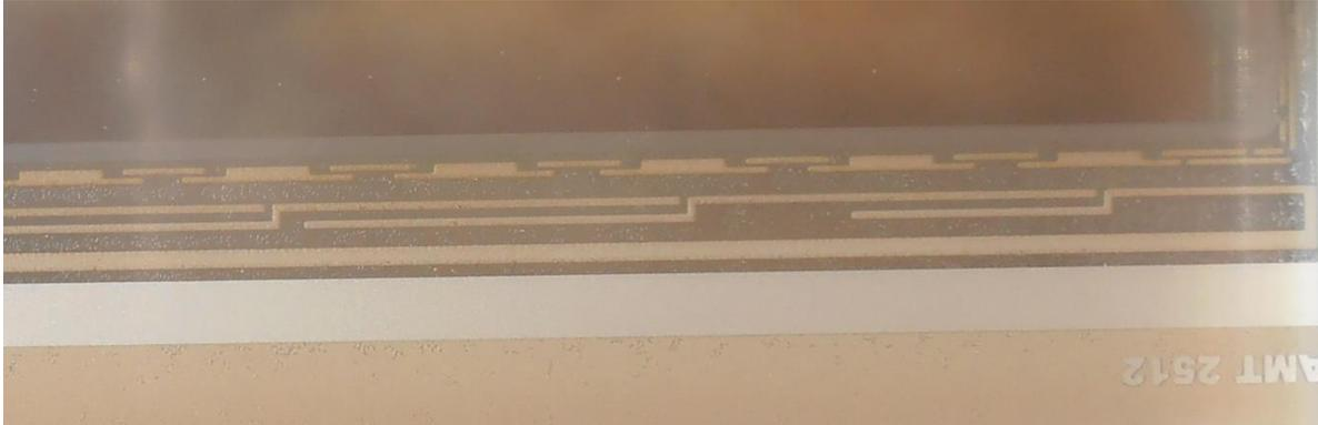
Abbildung 8: Rand eines 5-Draht-Touchscreens
