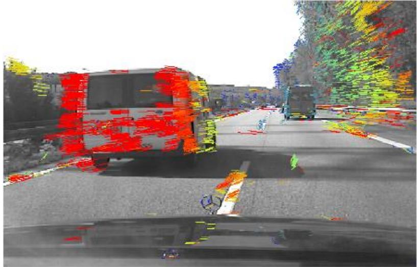
Abbildung 10: optischer Fluss bei Fahrerassistenzsystemen [10]
