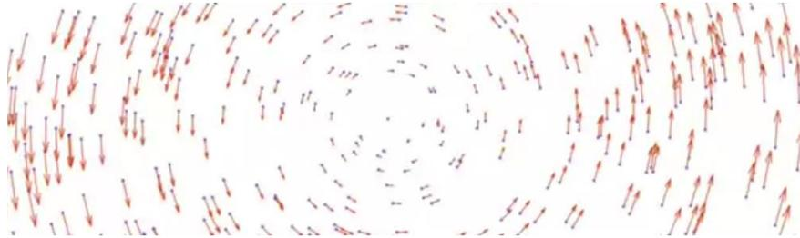
Abbildung 27: Geschwindigkeitsvektorfeld einer um die optische Achse rotierende Kamera [22]
