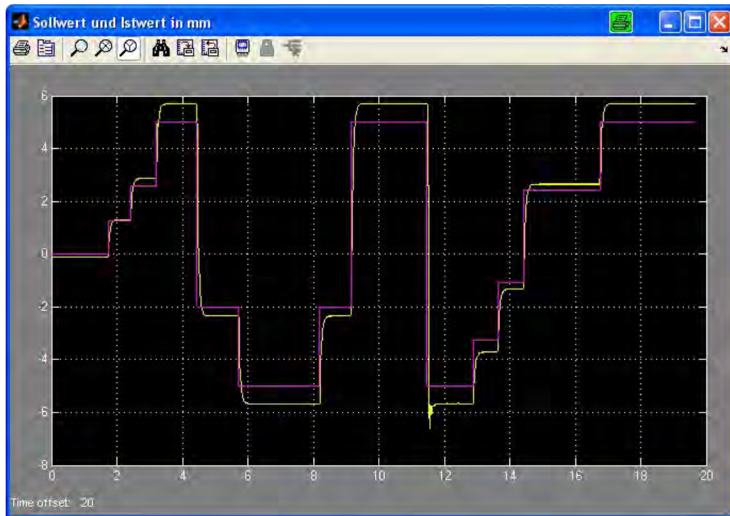
Abbildung 7.2: Sollwert und Position des Regelkreises mit PD-Regler
