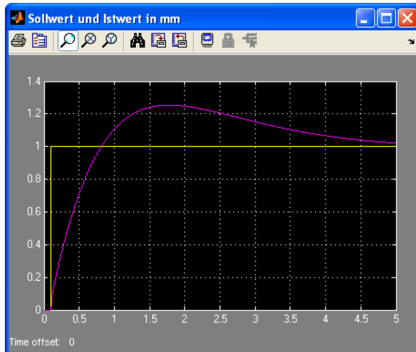
Abbildung 6.3: Simulierte Sprungantwort des Kreises mit PID-Regler
