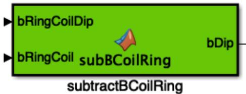
Abbildung 68 Matlabfunktion Block: Berechnung der magnetischen Flussdichte durch Subtraktion des äußeren Magnetfelds
