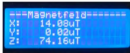
Abbildung 6.5: Messung des Erdmagnetfelds
