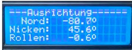
Abbildung 6.3: Ausgegebener Nickwinkel bei  $\varphi_{Nick_{Stell}} = 45,0^\circ$
