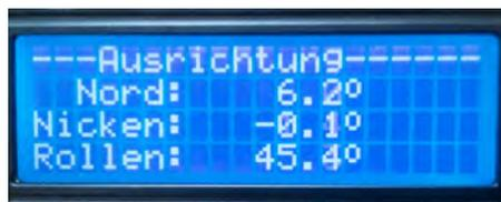
Abbildung 6.4: Ausgegebener Rollwinkel bei  $\varphi_{Roll_{Stell}} = 45,0^\circ$
