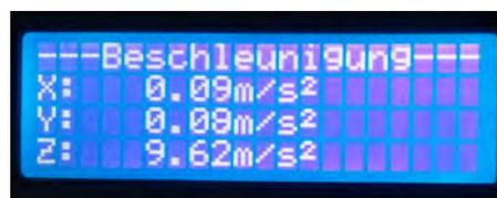
Abbildung 6.6: Beschleunigungsmessung bei waagrechter Montage des MPU-6050
