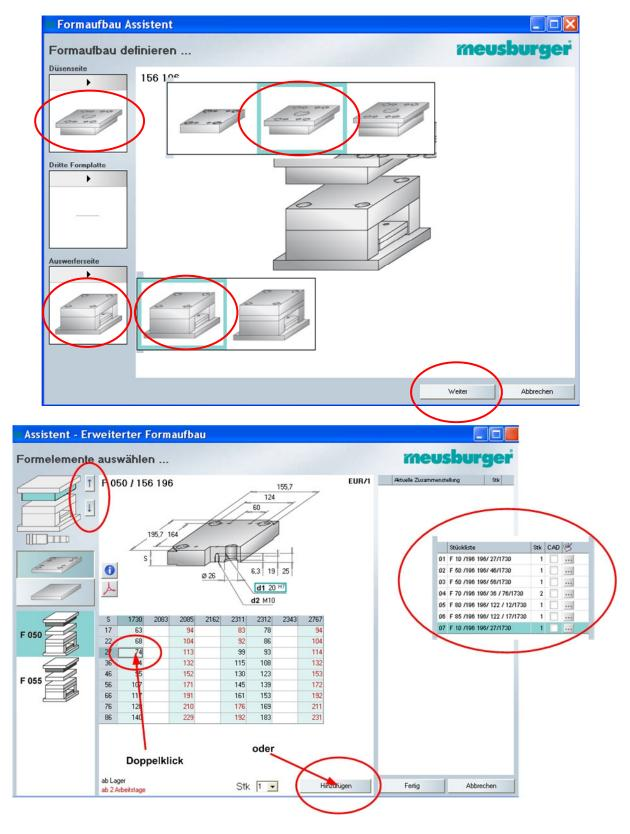
Für jede Platte Dicke und Werkstoff festlegen und mit den Pfeilen nach oben oder unten zu den jeweiligen Platten weiterschalten, rechts werden die gewählten Platten abgelegt.
