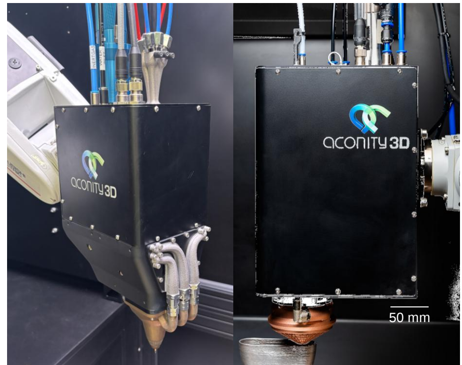
Abb.1: Vergleich: Multi-Draht-Kopf/ Single-Draht-Kopf
