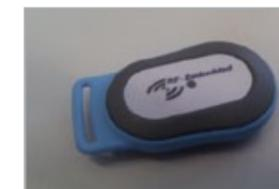
Abbildung 3: RFID-Transponder
