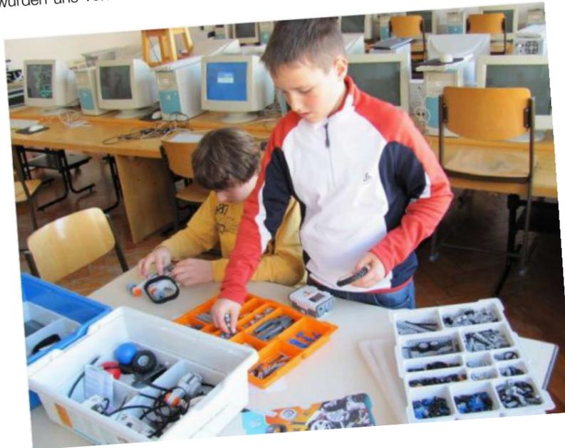
Zu jedem Set gehören 3 Motoren, verschiedene Sensoren und unzählige LEGO-Bausteine. Das Ganze ähnelt sehr den bekannten LEGO-Technik Baukästen. Der Unterschied liegt in der zentralen Steuer-Einheit, ein programmierbarer „Kasten“, der wie ein kleiner „Mini-Laptop“ immer mitfährt. Diese Steuereinheit kann über eine eigene Software über die Schul-PCs programmiert werden.
