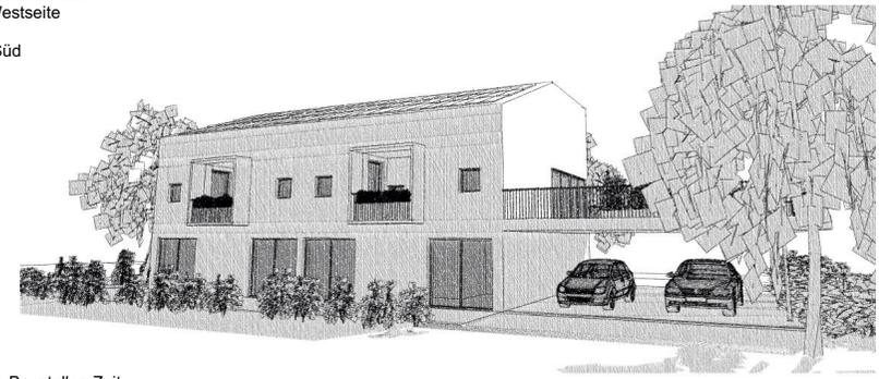
Die Konstruktion des Gebäudes soll in eine Modularen, beziehungsweise Raummodul Holzbauweise ausgeführt werden. Diese Bauweise hat den Vorteil das eine verkürzte Baustellen Zeit erreicht wird, da ein sehr großer Teil in den Werkstätten Vorgefertigt wird. Zudem ist der Werkstoff Holz ein wieder Wachsendes Material, welches optimale ökonomische und ökologische Eigenschaften besitzt.
