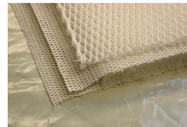
Für die Ausstattung des Innenraumes werden neue Materialien und Materialkombinationen erprobt. So wird beispielsweise überprüft, ob man bei den Matratzen des Innenraumes auf Schaumstoff verzichten und statt dessen räumlich gestrickte Gewirke einsetzen kann. Diese nehmen weder Wasser noch Feuchtigkeit auf und bieten hohen Komfort.
