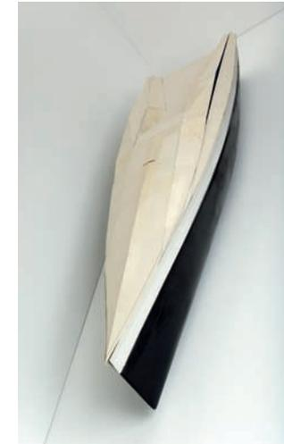
Im ersten Semester des Forschungsprojektes (Sommersemester 2009) wurden von den Studierenden Modelle im Maßstab 1:5 aufgebaut. In eine Rumpfschale aus glasfaserverstärktem Kunststoff wurden Ein- und Aufbauten aus Graupappe eingebaut und mit unterschiedlichen Aufteilungen der Funktionszonen und Räume experimentiert. Es wurde schnell deutlich, dass sich das Innere und das Äußere einer Yacht nicht voneinander trennen lassen, sondern sich gegenseitig bedingen.
