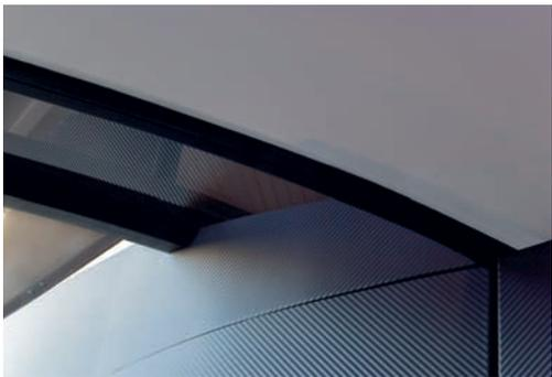
Das Materialkonzept des Innenraumes der YSA 17 verbindet geschickt die aus Sichtkohlefaserlaminat bestehenden harten und schwarzen Oberflächen mit den aus 3D-Gewirke oder PTFE-Gewebe bestehenden weißen Oberflächen, da alle eine textile Anmutung aufweisen. Weitestgehend alle Funktionen des Innenraumes wurden in die glatte Haut der Sichtkohlefaserlaminat integriert, wodurch Verletzungen der Crew bei unerwarteten und heftigen Bewegungen des Schiffes effektiv entgegengewirkt wird.
