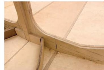
Immer wieder muss mit dem Auftraggeber und den für die Statik zuständigen Schiffingenieuren abgeklärt werden, ob bestimmte Verstärkungen der Rumpfschale wie Spanten oder Stringer in ihrer Lage verändert oder in ihrer Höhe angepasst werden können, um Kollisionen mit dem innenräumlichen Konzept zu vermeiden.
