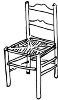
**Bei dem Zargenstuhl ...** wird ein Konstruktionsprinzip angewendet, bei dem Zargen, also Querträger, in fester Verbindung zu den vertikalen Beinen das Skelett des Stuhles oder Hockers bilden auf das wiederum additiv eine Sitzfläche oder Rückenlehne aufgesetzt wird.
