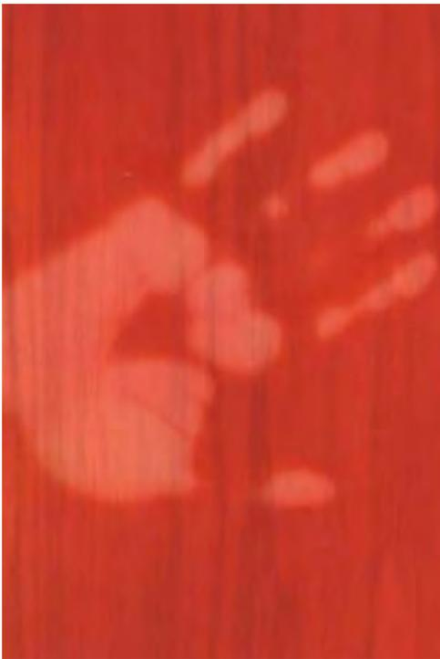
Abb. 81 | Thermochrome Farben reagieren auf Temperaturen und damit zum Beispiel auf menschliche Berührung
