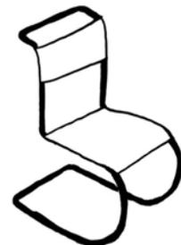
**Stühle in Freiform aus Schichtholz, Kunststoff, etc. ...** sind in den vergangenen 100 Jahren in einer Vielzahl entwickelt worden. Die wichtigste Gemeinsamkeit ist, dass die Formgebung die Stabilität bestimmt. Durch Kurven, Krümmungen und Falze entsteht Formstabilität.
