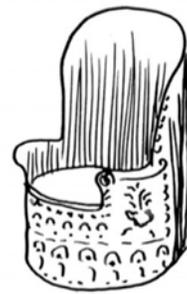
**Kistenhocker, Kastensitze ...** sind aus Brettern und Leisten in fester Verbindung zusammengesetzte kubische Gebilde. Die Verbindung erfolgt meist durch Verzinkung oder Verzapfung. Zur Versteifung des Brettergefüges sind die Stützbretter oft in halber bis dreiviertel Höhe mithilfe von Stegen verbunden.
