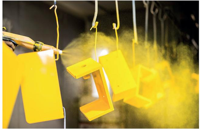
**Abbildung 27: Pulverbeschichtungsverfahren. [81]**
