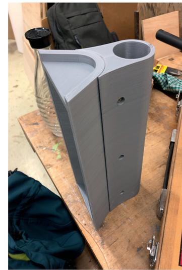
**Technische Innovationen** Um die verschiedenen Möbelemente des Konzeptes »Möbiliar« an den *Airline Beams* befestigen zu können, wurde von dem Studierendenteam ein Spezialbeschlag entwickelt, als Prototyp umgesetzt und im Einsatz getestet.
