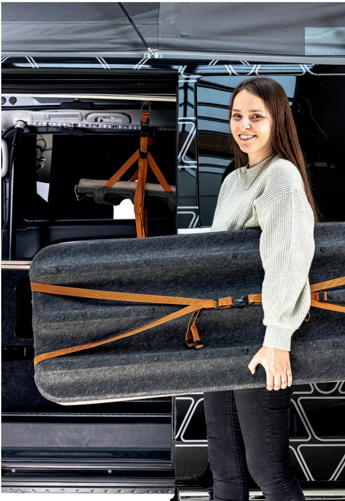
**Zusatzbetten** Neben den beiden Schlafplätzen im Hubdach wurden von dem Studierendenteam ein dreiteiliges Zusatzbett neu entwickelt, das über die *Airline*-Schienen an der Decke eingehängt werden kann. Durch die Segmentierung kann es auch als Kinderbett verwendet werden, wenn kein klassischer Schlafplatz benötigt wird. Für das Einhängen kommen Spezialbeschläge zum Einsatz.
