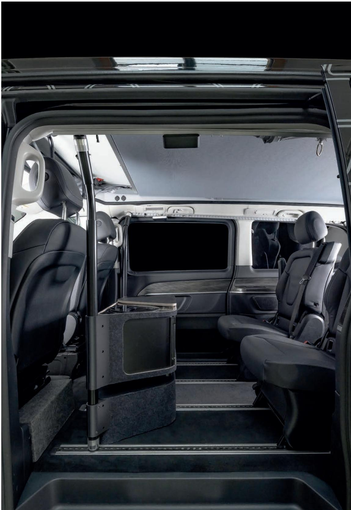
**Flexible Montagepunkte** Das Konzept des Projektes 1 »Möbiliar« beruht auf dem Einbau sogenannter *Airline*-Schienen an Boden und Decke des Fahrzeuges, in den modifizierten *Airline-Beam*-Sperrbalken als vertikale, universelle Montagepunkte für die Möblierung des Vans eingesetzt werden.
