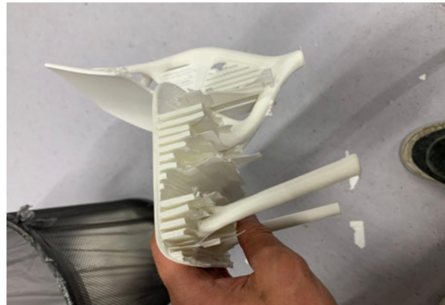
Herausbrechen der Stützstruktur
