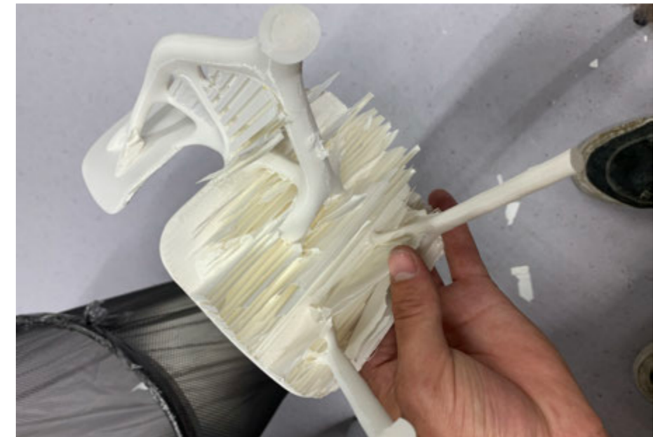
Herausbrechen der Stützstruktur
