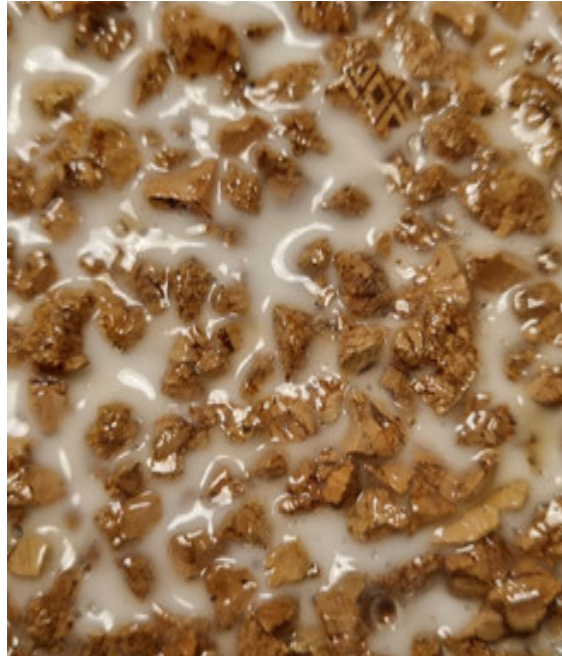
mischung - korkgranulat holzleim
