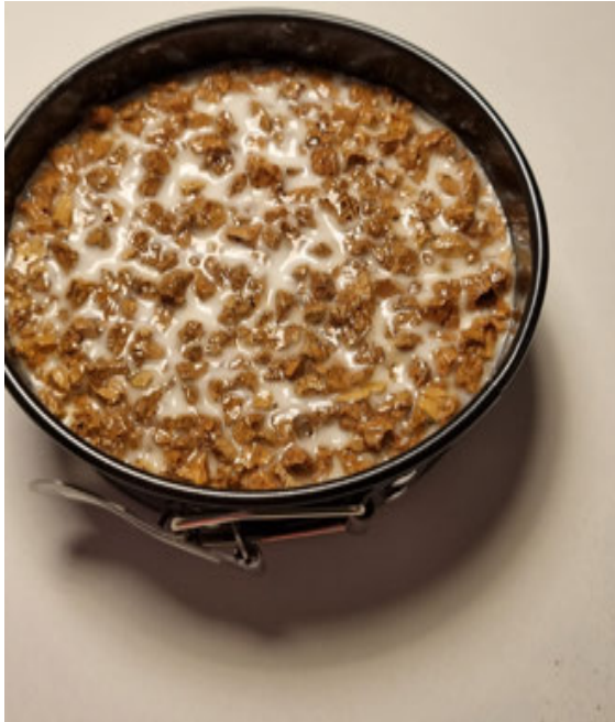
mischung - korkgranulat holzleim
