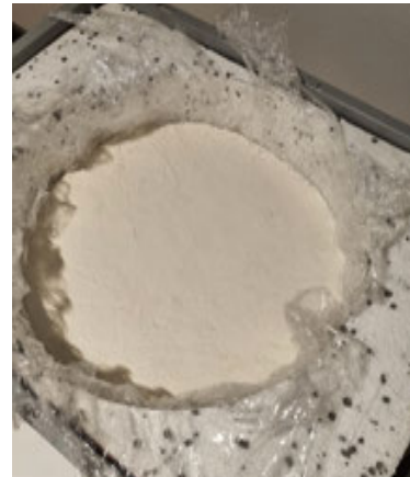
pulpe - holzleim spachtelmasse toilettenpapier
