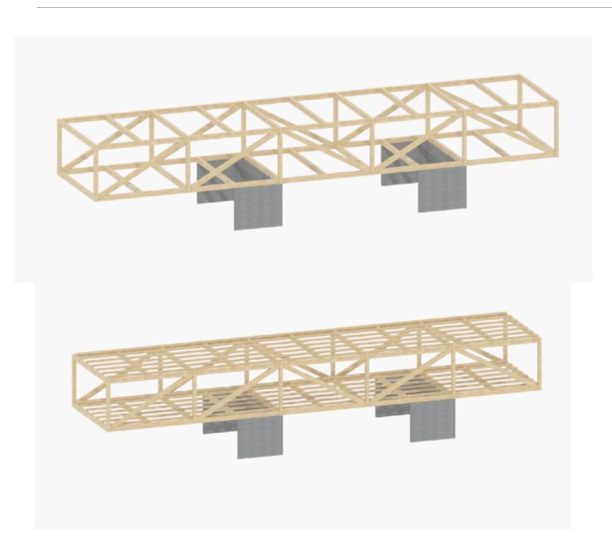
Das Haupttragwerk unseres Gebäudes besteht aus zwei Fachwerkträgern in Holzbauweise mit zwei Auflagerpunkten entsprechend des Sockelgeschosses.
