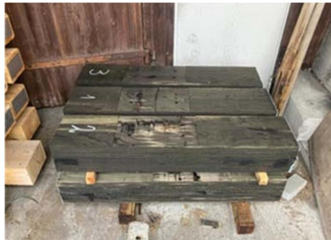
Bild 4: Schutzmittelimprägnierte Holzschwellen aus Buchenfurnierschichtholz
