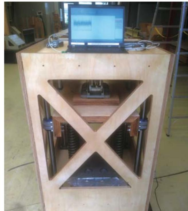
Bild 2: Prüfstand für zyklische Belastung von Wohnwagenkurbelstützen
