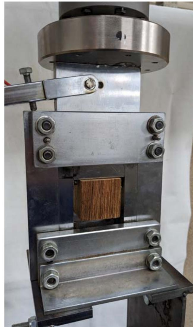
Bild 5: Blockscherversuch von schutzmittelbehandeltem LVL aus Buche in Anlehnung an EN 14080 : 2013 Anhang D
