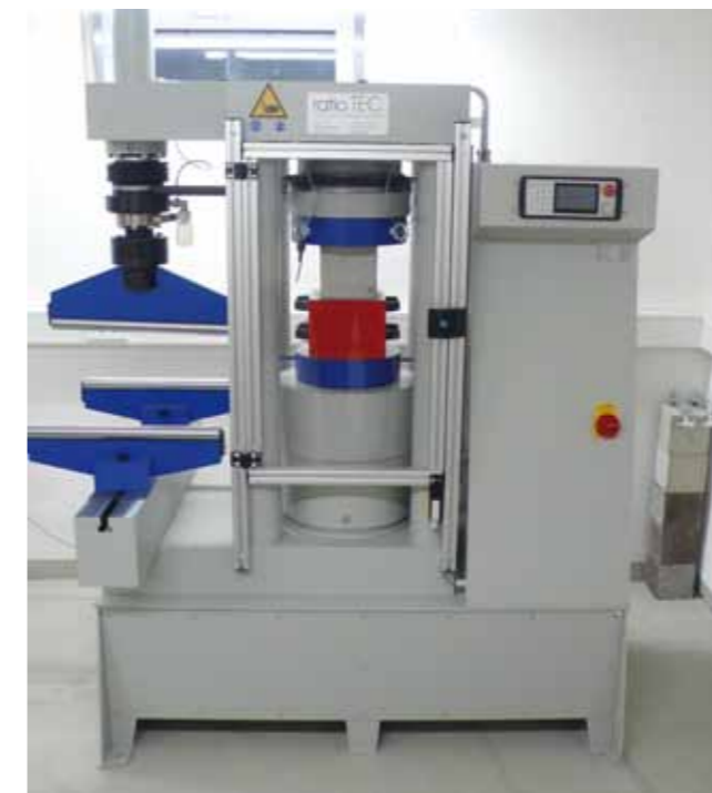
Bild 4: Kombinierte Druck-/Biegeprüfmaschine Labor für Baustoffe
