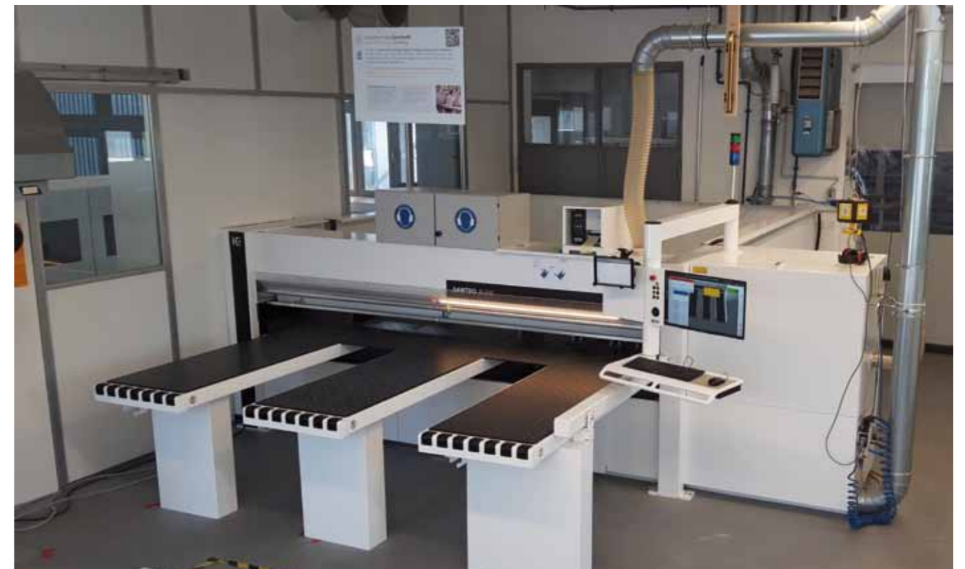
HOMAG SAWTEQ B-200 – LED-Assistenzsystem (hier: gelb) markiert Werkstückposition lt. Schnittplan
