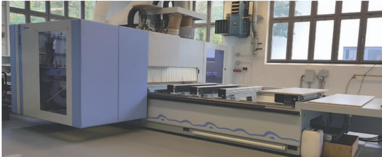
HOMAG BMG310/42/F/V/K – Die Bearbeitungsmaschine für die Fräsprojekte (ÜVA, Gebäude L0.09)
