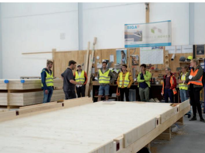
Bild 1: Bodenplatte eines Holzraummoduls
