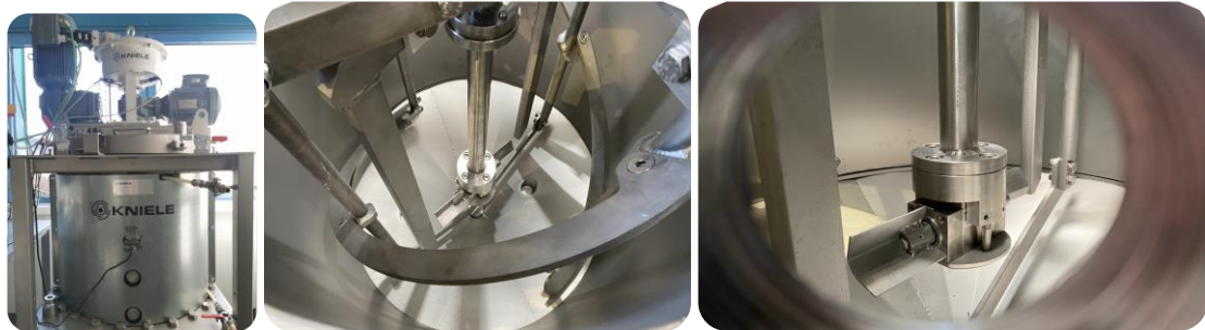
Abbildung 4: 3-Achsen-Mischer aus vorangegangenem Forschungsprojekt
