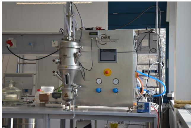
Abbildung 2: Verfügbare Labor-Wirbelschichtanlage der Firma DMR
