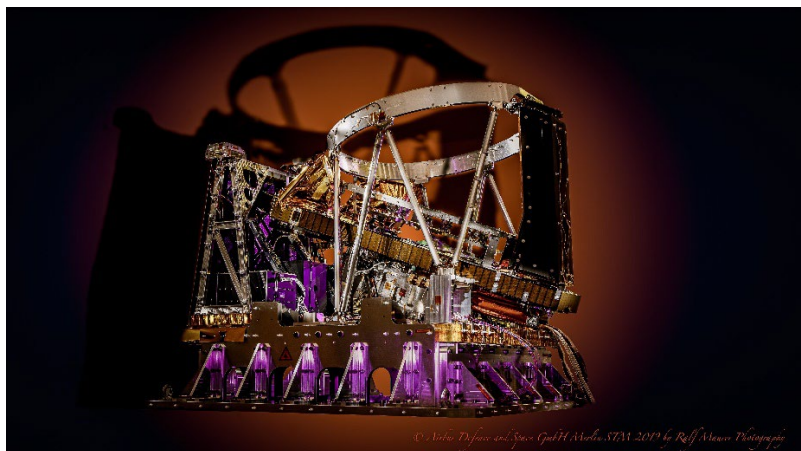
Links: MERLIN Satellit in niedrigem Erdorbit bei der Messung; Rechts, Nutzlastinstrument mit LIDAR
