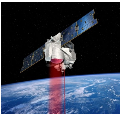
Links: MERLIN Satellit in niedrigem Erdorbit bei der Messung; Rechts, Nutzlastinstrument mit LIDAR
