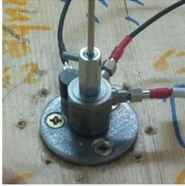
**Abbildung 24** Anbindung des Impedanzmesskopfes an die Struktur.
