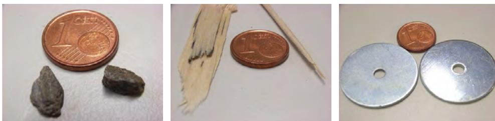
**Abbildung 5.10:** Gegenstände, deren Einfluss als Störung der Standfläche untersucht wird.
