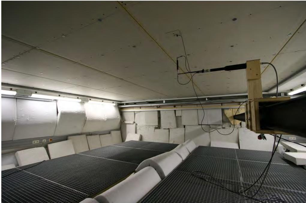
**Abbildung 3.11:** Empfangsraum mit Absorbermaterial zur Bedämpfung. Der Raum bleibt über die begehbaren Gitter voll zugänglich. Die Sonde ist so befestigt, dass die Mikrofone in horizontaler Richtung ca. 50 cm von dem Schlitten des Verfahrensystems entfernt sind.
