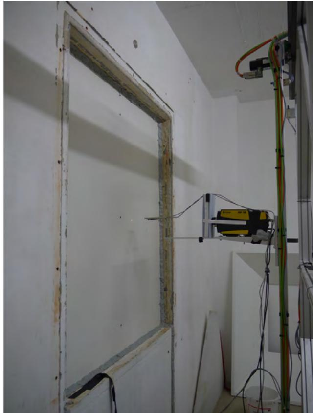
**Abbildung 8.3:** Fenster mit Intensitätsmesssonde und Laserdopplervibrometer [3] [50], Quelle: Müller-BBM
