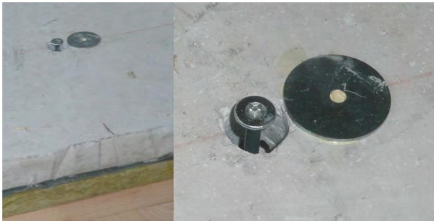
**Abbildung 4.32:** Positionierung einer Schraube in der Rohdecke durch eine Bohrung im Estrich. Messung der Rohdeckenbeschleunigung durch magnetisch befestigten Beschleunigungsaufnehmer auf dem Schraubenkopf. Beschleunigungsmessung des Estrichs durch Platzierung des Aufnehmers mittels eines Magneten auf der mit dem Estrich verklebten Karosseriescheibe.
