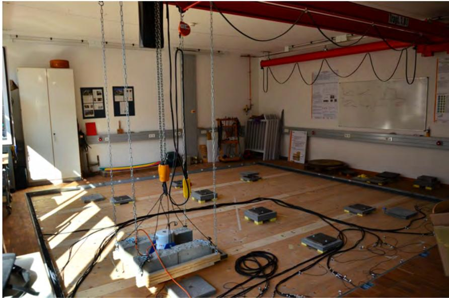
**Abbildung 5.11:** Brettsperrholz-Decke aus Leno105 mit Tilgern bestückt.
