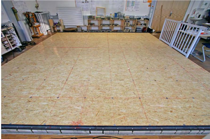
**Abbildung 2.5:** Fertige Rohdecke der Holzbalkendecke mit Beplankung
