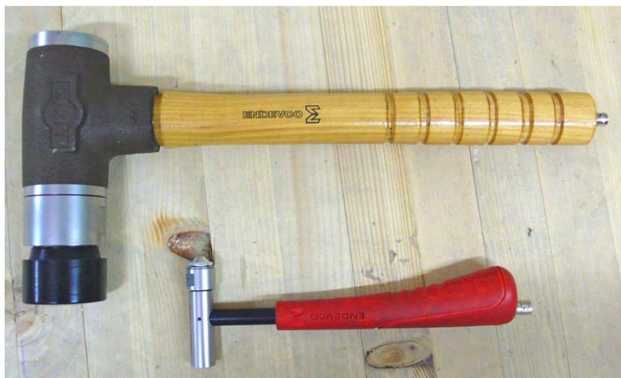
**Abbildung 3.7:** Zwei unterschiedliche Modalhämmer der Firma Endevco. Beide Hämmer haben auswechselbare Kontaktflächen unterschiedlicher Härte.
