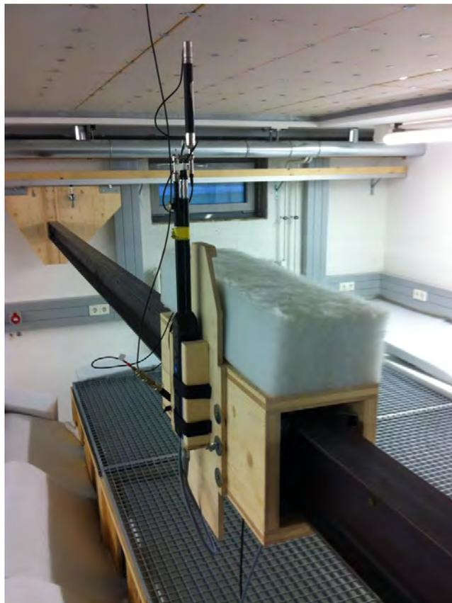
**Abbildung 3.10:** Verfahrenssystem mit Befestigung der Intensitätssonde auf dem Verfahrenschlitten.
