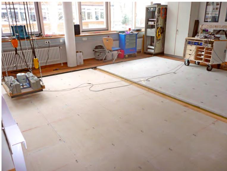
**Abbildung 2.18:** Trockenestrich (links) und Fließestrich (rechts) auf Leno162 Decke im Prüfstand
