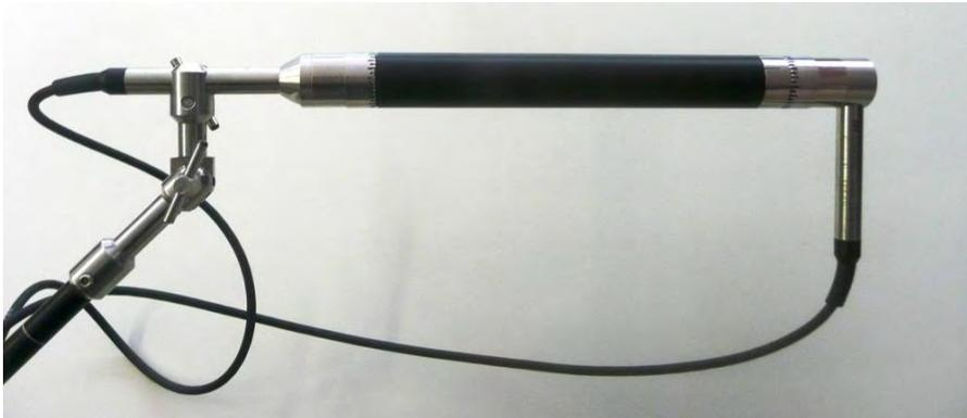
**Abbildung 3.9:** Zweimikrofonsonde (pp-Sonde) vom Typ Norsonic 240 mit einem 100 *mm* Spacer zwischen den beiden Kondensatormikrofonen.
