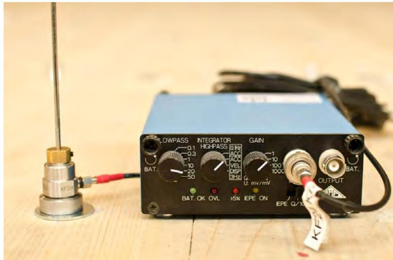
**Abbildung 3.6:** Kraftsensor vom Typ KF24 mit Ladungsverstärker vom Typ M68
