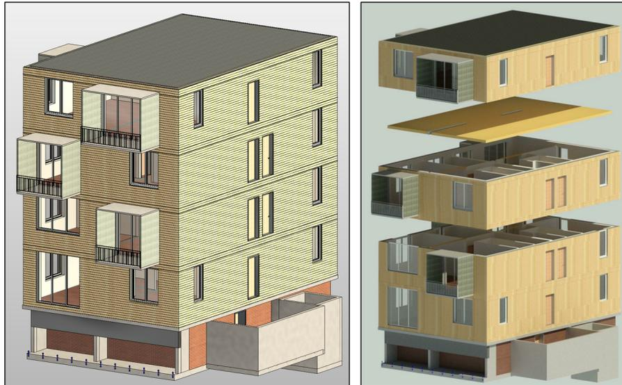
**Abbildung 14** BIM Referenzmodell eines realen Bauvorhabens, H4 Bad Aibling
